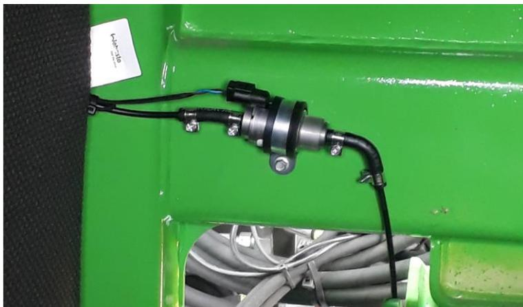
Проложить топливопровод и электрическую проводку от отопителя до насоса-дозатора. Обеспечить защиту от острых кромок резиновым шлангом, крепить хомутами.
