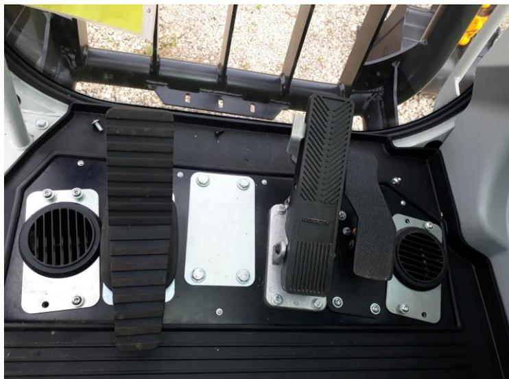
Соединить отопитель и дефлектора воздуховодом, закрепить все соединения хомутами.
