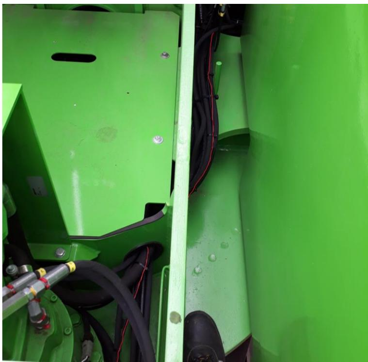
Расположение насоса-дозатора на задней стенке отсека под кабиной оператора.
