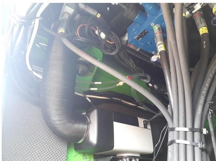
Прокладывать воздуховоды следует с как можно более низким сопротивлением потоку.
