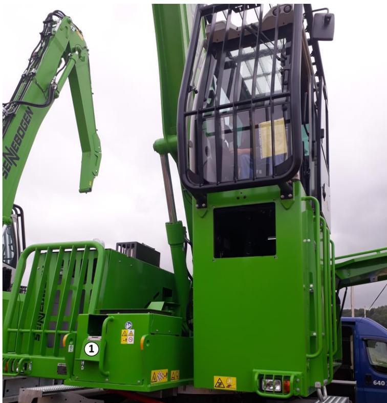
Топливный бак смонтировать в обозначенном месте. По требованию заказчика установлен топливный бак стороннего производителя.
