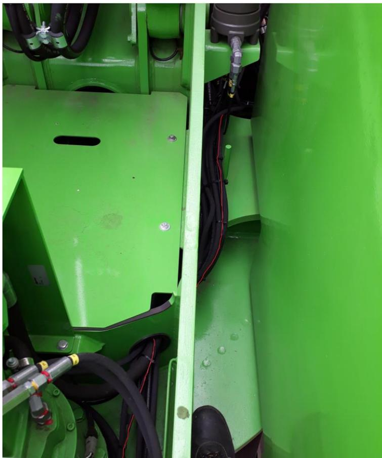
Проложить топливопровод и электрическую проводку до подогревателя. Обеспечить защиту от острых кромок резиновым шлангом, крепить хомутами.
