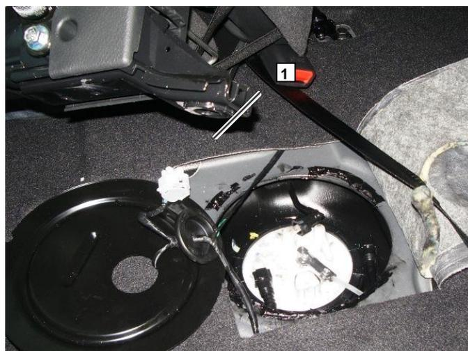
Просверлить отв  $\varnothing$  6мм, установить топливозаборник, укоротить топливную трубку 1 таким образом, что бы до дна бака был зазор около 25мм.
