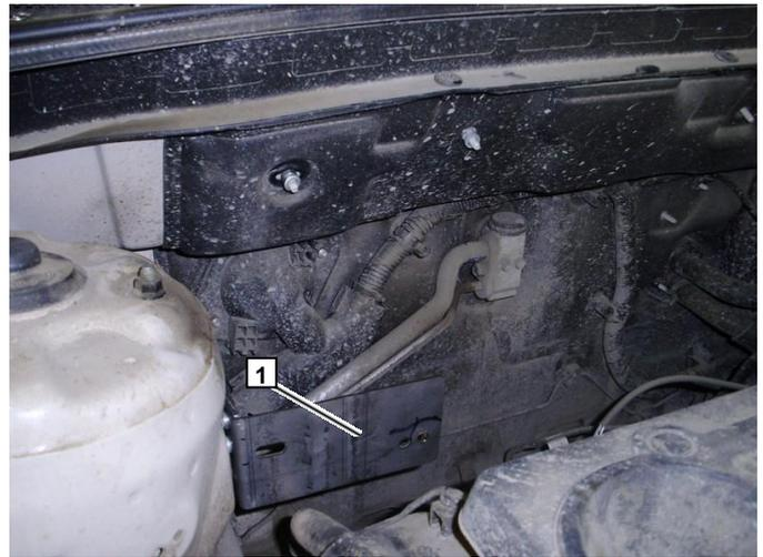
1 для фиксации кронштейнов на отопитель использовать 3 специальных самореза
