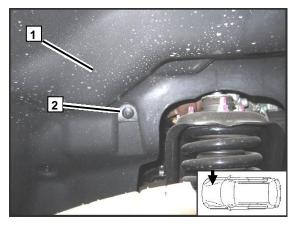
Закрепить кронштейн отопителя 1 через штатное отверстие под пистон крепления подкрылка 2
