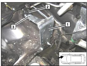
Закрепить растяжку **2** и кронштейн отопителя **1 3** Болт M6x15, шайба, гайка с фланцем
