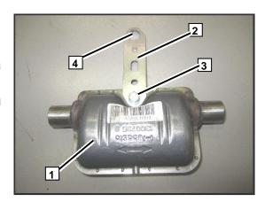
Закрепить монтажную пластину **1** с глушителем на раме а/м, используя штатное отверстие с резьбой **2** Монтажную пластину изогнуть по месту
