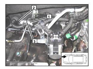
В самом низком месте перегиба впускной трубки 1 сделать отверстие 2 Ø 3 мм (для слива воды, попавшей в воздухозаборник)
