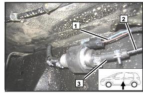
Проложить топливопровод **1** от насоса-дозатора в подкапотное пространство вдоль штатных топливных линий **2**
