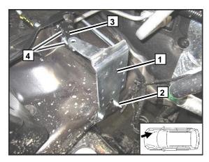
Отрегулировать положение кронштейна отопителя 1, чтобы он стоял ровно вертикально
