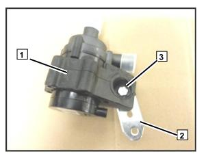
В согнутой «лапе» кронштейна сделать отверстие  $\varnothing$  6,5 мм и закрепить монтажную пластину с циркуляционным насосом так, чтобы выходной штуцер насоса был направлен к входному штуцеру отопителя
