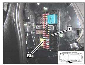
Сняв (или частично приоткрыв) заднюю крышку салонного блока реле и предохранителей, добраться до проводов, идущих от предохранителя F37 7,5 А. Два желто-красных провода уходят от предохранителя, один из них 1 делает петлю и возвращается обратно в блок предохранителей, второй 2 выходит из блока и идет в жгут. Подключение производится ко второму проводу (идущему в жгут). Необходимо перерезать его на достаточном для подключения расстоянии.
