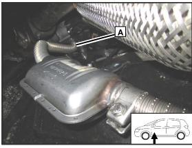
Изогнуть конечную часть выпускной трубы **B**, как показано на рисунке
