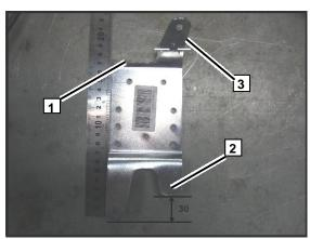
Изготовить растяжку длиной 125 мм, согнуть по линии сгиба  ${\bf 1}$  на  $90^\circ$
