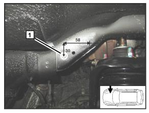
Сделать отверстие **1** Ø 6,5 мм в панели кузова и в укороченной лапе кронштейна
