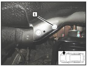
Окончательный вид закрепленного кронштейна отопителя 1
