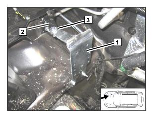
Разметить место отверстия для крепления укороченной «лапы» кронштейна
