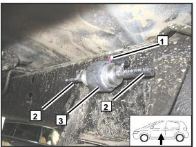
Проложить топливопровод от топливозаборника до насоса дозатора вдоль штатных топливных линий
