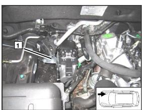
Снять «горячий» шланг **1** с трубки радиатора печки (двигатель выход/радиатор печки вход) Штатный хомут **2** больше не потребуется Шланг **1** требуется укоротить на 160 мм
