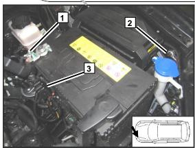
Подключение питания отопителя и предохранители
