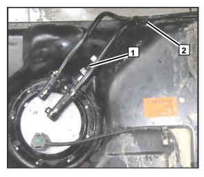
Удалить из резинового крепления насоса дозатора металлическую втулку
