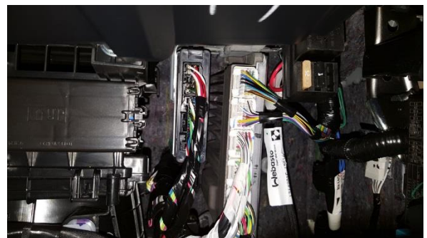
Колodka предохранителей в салоне Крепление к штатному месту.
