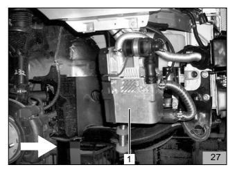
Vormontiertes Heizgerät mit drei Karosseriescheiben A7,4 und Bundmuttern (28/1,2,3) gemäß Bild 28 befestigen
