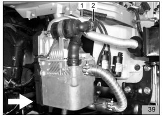
Wasserschlauch (40/2) durch fahrzeugeigene Durchführung (40/1) gemäß Bild 40 in den Motorraum führen
