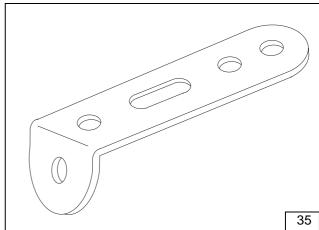
Abgewinkeltes Lochband (36/2) gemäß Bild 36 an fahrzeugeigenem Stehbolzen mit Bundmutter (36/1) befestigen
