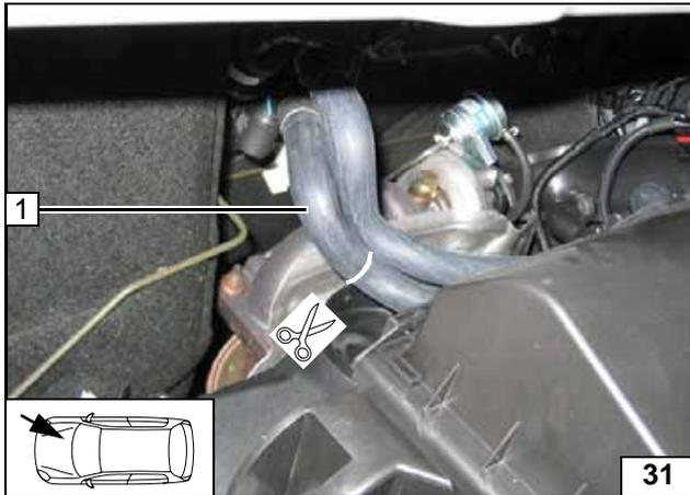
1 Schlauch Motorausgang / Wärmetauschereingang
