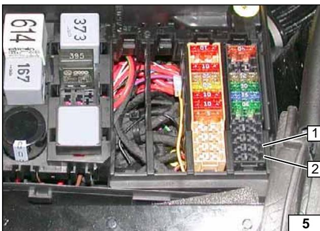
Abgetrennte Leitungen von Sicherung F1 und F2 mit Powertimer in freie Steckplätze vom Sicherungs- und Relaisräger einsetzen.
