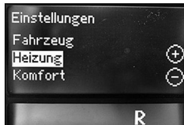
Кнопками +/- справа на руле установить одно из трех моментов включения, а кнопками вверх/вниз и кнопками +/- время включения подогревателя.
