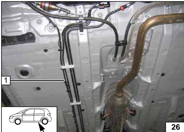
Brennstoffleitung und Kabelbaum Dosierpumpe **1** zur Spritzwand und weiter am Unterboden entlang der fzg.eigenen Kraftstoffleitungen zum Einbauort Dosierpumpe verlegen!
