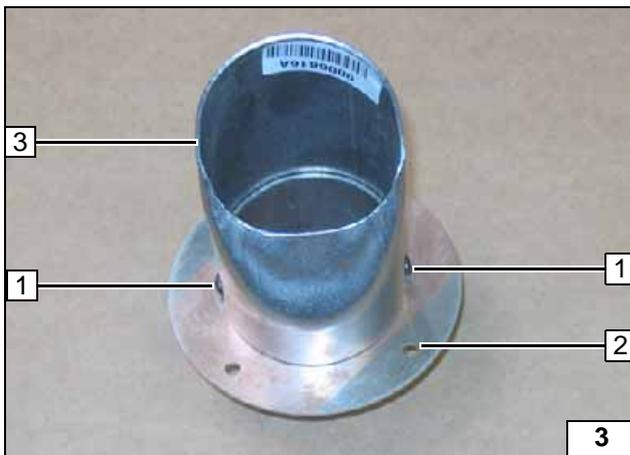
Ausströmer 3 auf Wanddurchführung 2 aufsetzen, gemäß Bild ausrichten!
