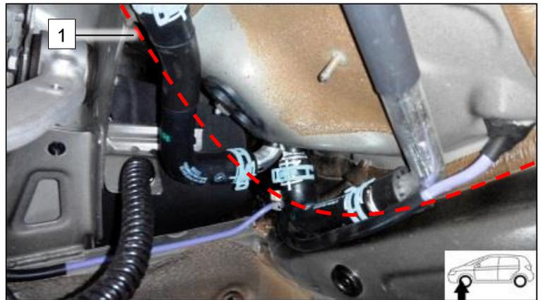
Провести топливопровод 1 со жгутом до места установки насоса-дозатора.
