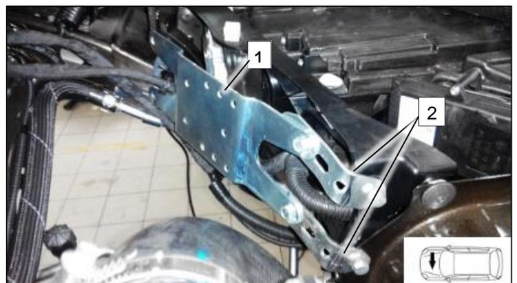
1 Отверстие Ø 7 мм, просверлить после разметки
