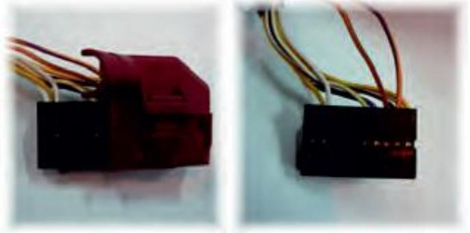
Пары проводов модуля, CAN 1 и CAN 3, предназначены для подключения к CAN-шине: CAN 3 подключается к шине со стороны блока управления климат-контролем, а CAN 1 — со стороны автомобиля.
