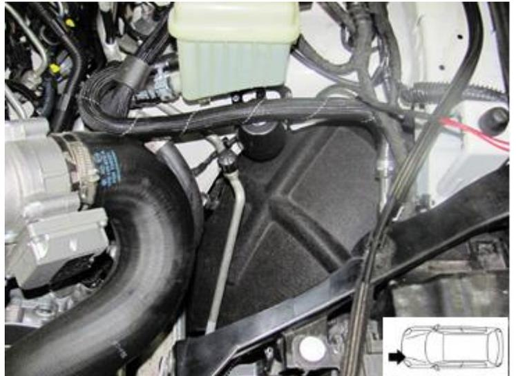
1 Штатные закладные гайки (2 шт) – используются для крепления кронштейна.
