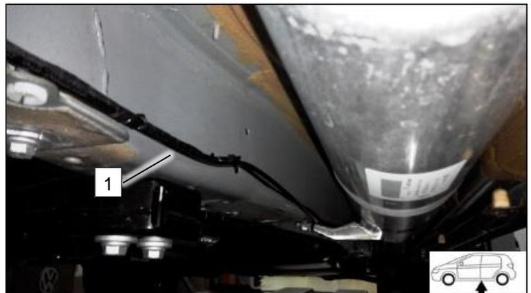
Топливный насос-дозатор 1 в резиновом суппорте закрепить за левым порогом в штатном отверстии.
