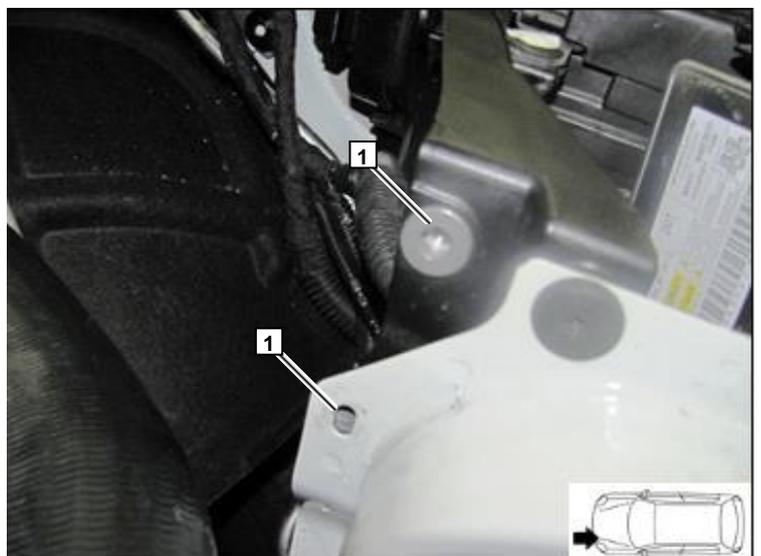
Закрепить кронштейн 1, с помощью монтажных пластин 2, болтов М6, гаек М6, гроверов.
