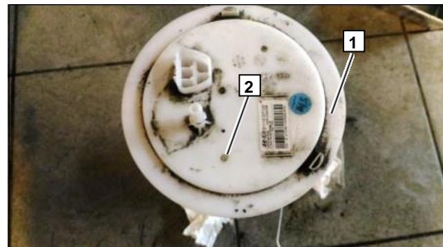
Спозиционировать заборник 1, как показано на рисунке. Зафиксировать гайкой. Рёбра жёсткости со стороны гайки компенсируются шайбой.
