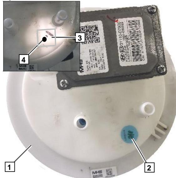
Сделать в крышке колбы 1 отверстие 2 Ø 6 мм
