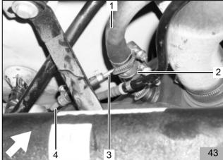
Mecanyl-Brennstoffleitung (1) vom Tankentnehmer ablängen und mit Schlauchstück und Schlauchschellen an der Saugseite der Dosierpumpe (2) anschließen
