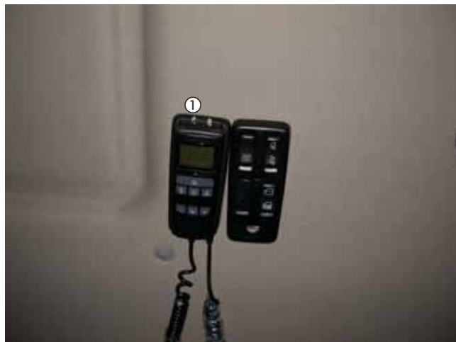
① CTT-Bedieneinheit / CTT control unit
