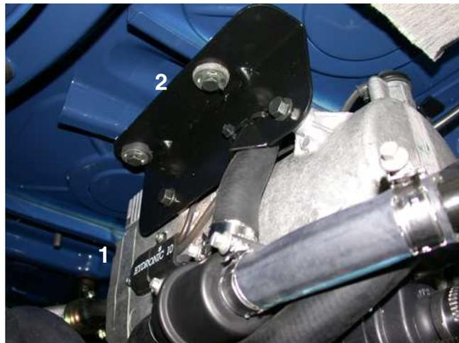
① Heizgerät / Heater      ② Halter / Bracket
