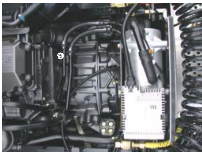
a Wasserrohre vom Heizgerät zum Wärmetauscher Water pipes from the heater to the heat exchanger
