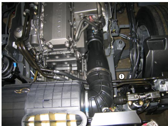
① Wasserrohre vom Heizgerät zum Wärmetauscher Water pipes from the heater to the heat exchanger
