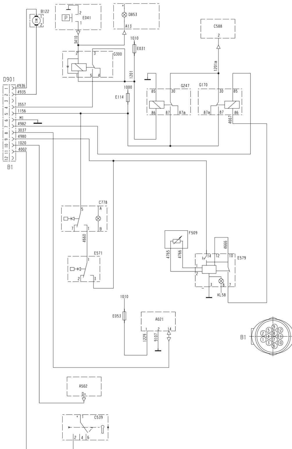
Das Microrelais G300 wird ab Chassis Nr. 0E56820E, Produktionsdatum ab 2001/41 durch 2 Dioden ersetzt.
