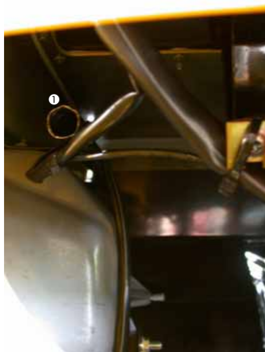
① Ansaugöffnung vom nach unten abgewinkelten, flexiblen Verbrennungsluftrohr Intake opening of the flexible combustion air pipe, angled downwards
