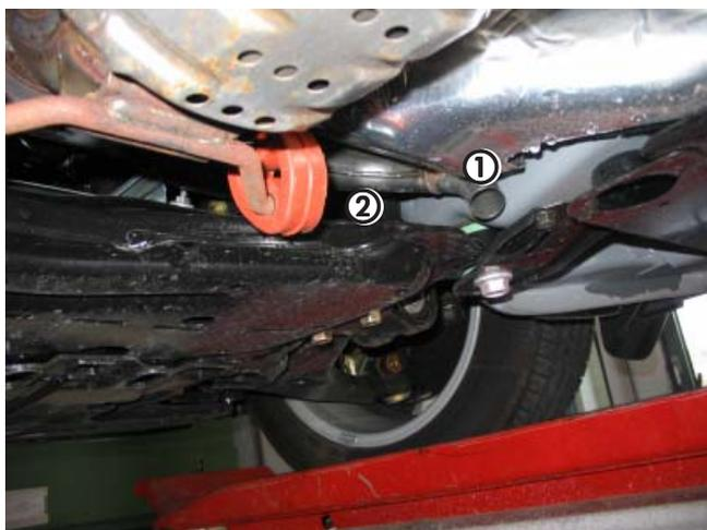
① Abgasschalldämpfer / Exhaust silencer
