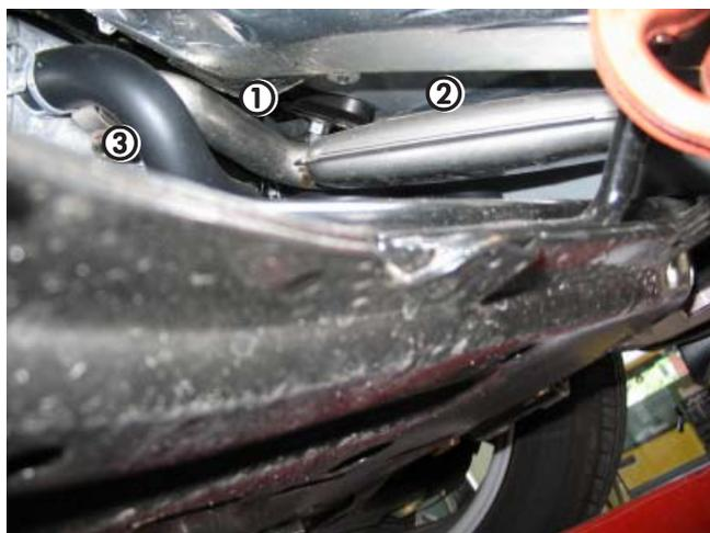
① Massives Abgasrohr / Solid exhaust pipe
