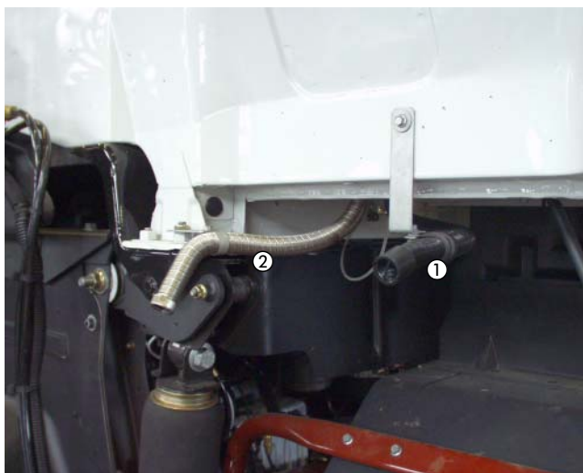
① Verbrennungsluftrohr / Combustion air pipe ② Abgasrohr / Exhaust pipe
