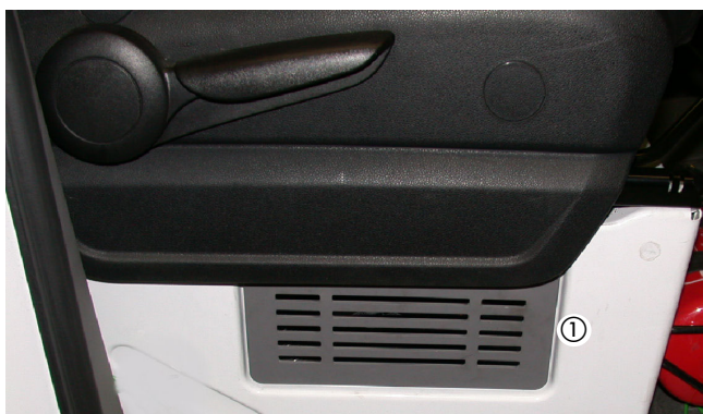
① Gitter seitlich im Sitzkasten Grating on the side in the seat box
