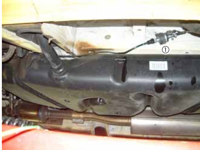
① Dosierpumpe / metering pump
