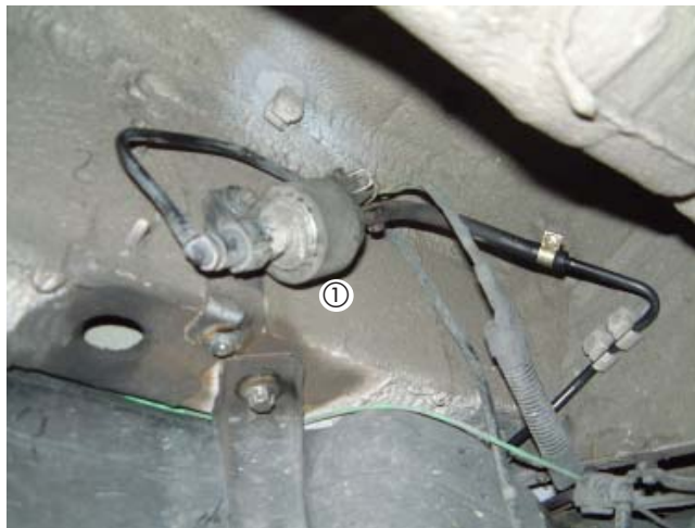
① Dosierpumpe / Dosing pump
