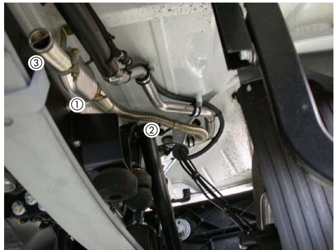
① Abgasschalldämpfer Exhaust silencer ② Abgasrohr Exhaust pipe ③ Abgasendrohr Exhaust end pipe
