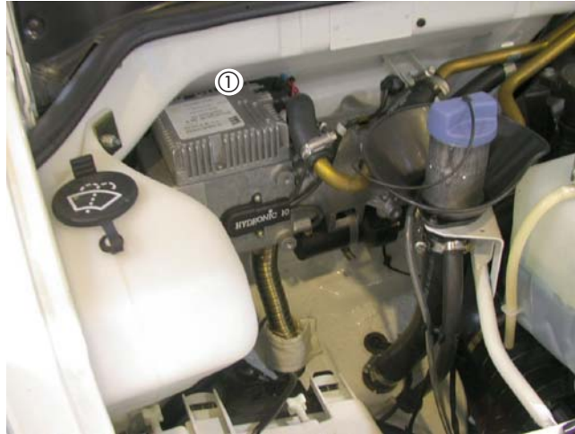
① Heizgerät befestigt an der Motortrennwand The heater is fixed to the engine partition panel
