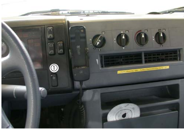
① Schalter Zuheizer / switch „Auxiliary heater“
